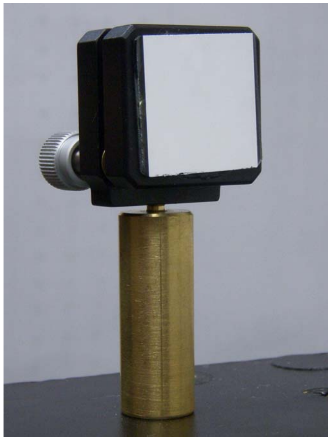
可変機構と調整ノブの付いたミラーと支柱(装置記号 B)。カバー紙が付いた状態で取り付ける。
