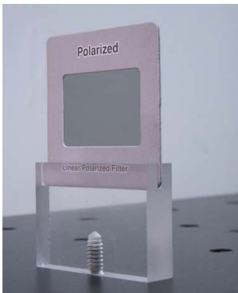
スライド枠に取り付けた偏光板がアクリル支持台（装置番号 J）に支えられている
