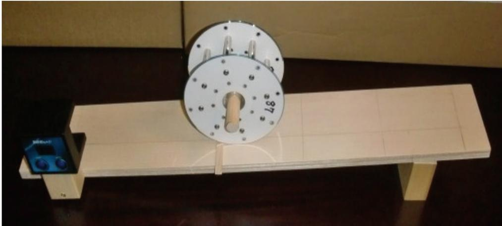
図 II.9 斜面台の途中に CD で作った回転体が置かれている。斜面左側に速度計測用のビースピが置かれている。
