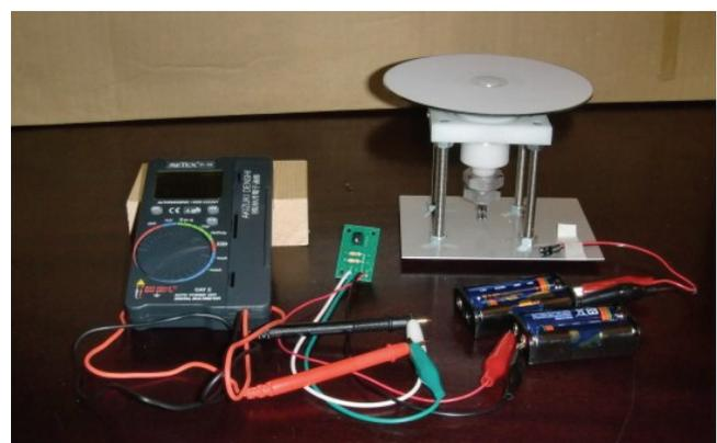
図 II.11 歳差運動実験器：CD 円板を下部に取り付けたモーター（白いプラスチックケースに入っている）で回す。全体が自由に傾けるように、四角いプラスチック板に取り付けられている。
