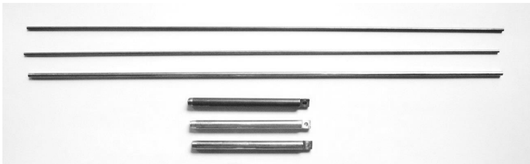
図 1-3 試料棒（上 3 本は電気伝導計測用、下 3 本は熱伝導計測用）
