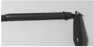
よくない接続法
