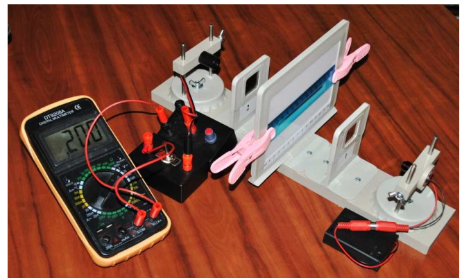
図 4B プラスチック定規を通して光の透過度を測定するためのセットアップ
