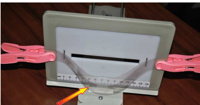
図 3B プラスティックリボンのスクリーンへの固定の仕方
