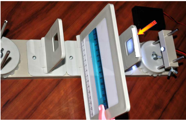
図 1B プラスティック定規の複屈折を観測するためのセットアップ
