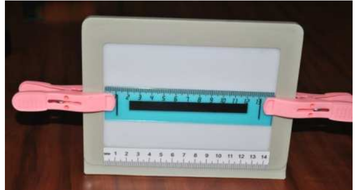
図 2B プラスティック定規のスクリーンへの取り付け方
