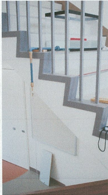
図 6 実験は教室内で行えないため、階段を使用して行った。この写真はチューブの長さが 5.0m のときで、チューブは約 1.5 階下まで続く。
