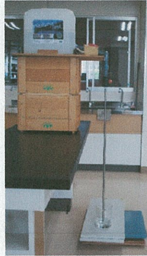
図2 両方の管への水圧が等しくなるようにタンクからパイプ（硬塩化ビニル管）で水路を2つに分け、同時に管へ水を送り込むことにした。しかし、逆流やコックをひねるタイミングのずれなどから生じる誤差を軽減するために片方ずつ実験をした。
