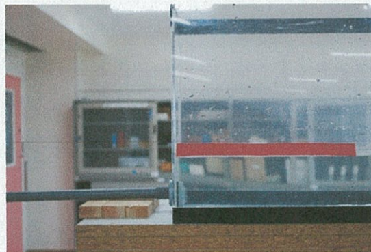
図 5 水面が赤いテープの下にくるようにし,テープの位置は穴の高さの 2 倍として実験に著しく水量が少なくならないようにした.
