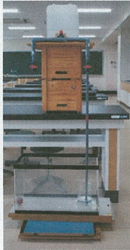
図2 両方の管への水圧が等しくなるようにタンクからパイプ（硬塩化ビニル管）で水路を2つに分け、同時に管へ水を送り込むことにした。しかし、逆流やコックをひねるタイミングのずれなどから生じる誤差を軽減するために片方ずつ実験をした。
