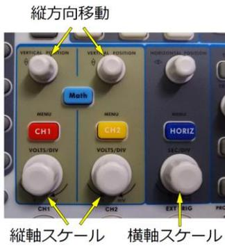
図 A-9 縦・横軸調整つまみ
