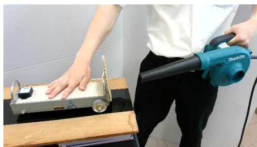
図11 走行させる前にブロワーの風を風受け用段ボールにあて、台車を手で抑える様子
