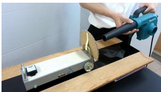
図10 力学台車を走行させる様子
