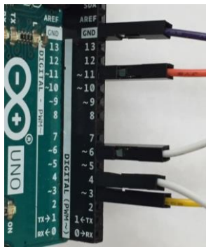
ピンは、最後までしっかりソケットに差し込む
