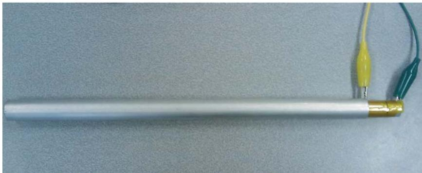
図 II.19 2 本のアルミ円筒からなる可変容量コンデンサー
