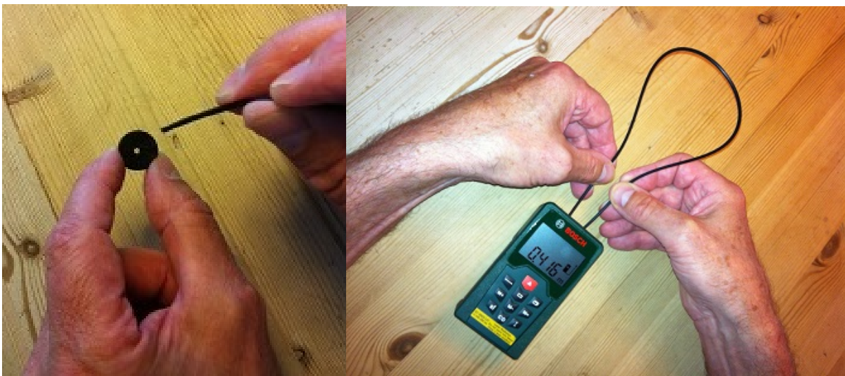
図 1.5 (a) フェルトのパッドと光ファイバーケーブル (b) 光ファイバーケーブルの取り付け方
