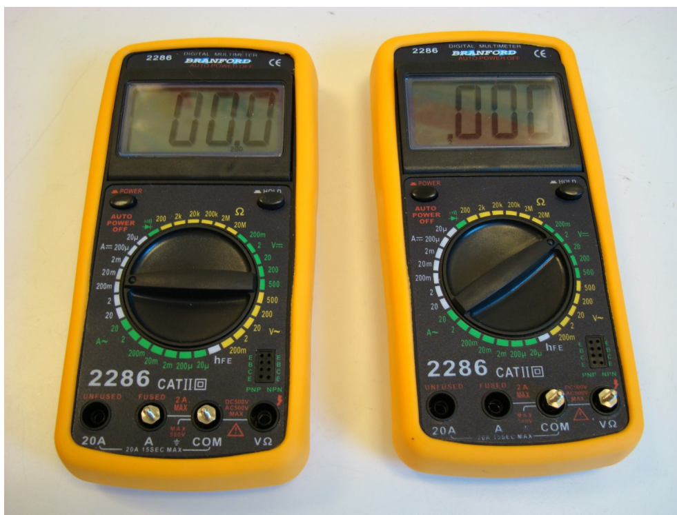
図 2.3 それぞれ、電流計 (左) や電圧計 (右) として使用するように端子を取り付け、切り替えダイヤルを合わせた状態のマルチメータ。左上の「POWER」ボタンを押すことで装置のスイッチが入る。ある時間使用しないと自動的にスイッチが切れる。この装置は、交流電流や電圧( \sim )と、直流電流や電圧(=)を測定できる。電圧計の内部抵抗は、測定レンジによらず 10\text{M}\Omega である。測定レンジによらず、最大の読みでの電流計の電位差は 200\text{mV} である。測定範囲を超えた場合には「1」が表示され、より上の測定レンジを用いる必要がある。測定値の表示を保持する場合以外、右上の「HOLD」ボタンを押してはいけない。
