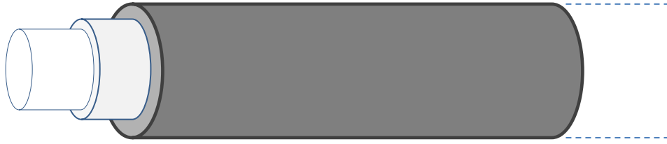
図 1.4 光ファイバーケーブルの略図。
