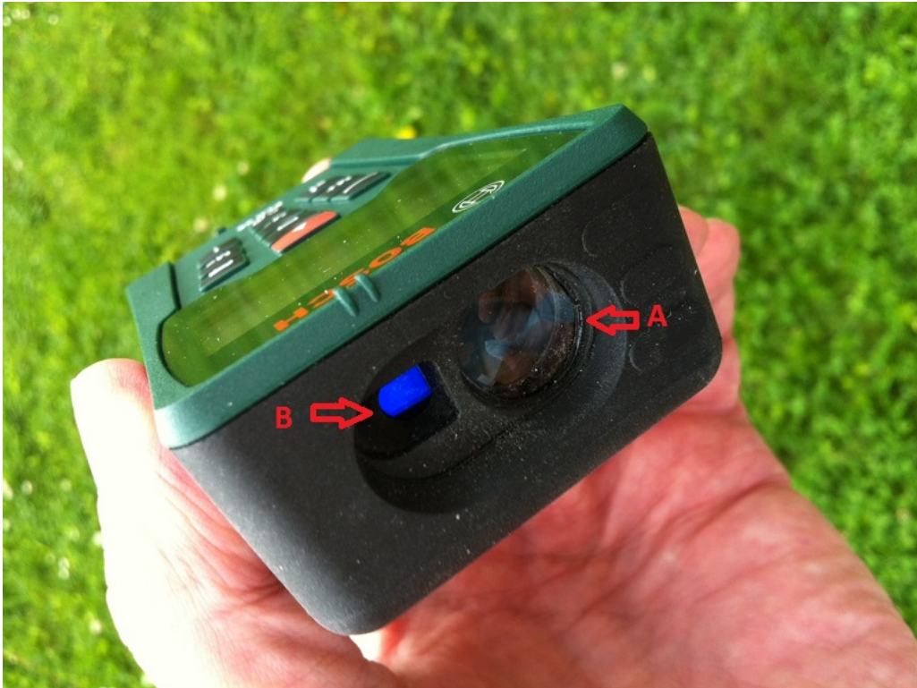
図 1.3 前面から見たレーザー距離計
