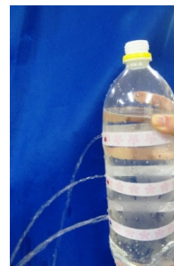
図1 ペットボトルに入れた水が穴から出るようす
