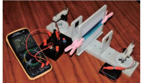
図III.26 プラスチック定規の透過光を測定するセットアップ。
