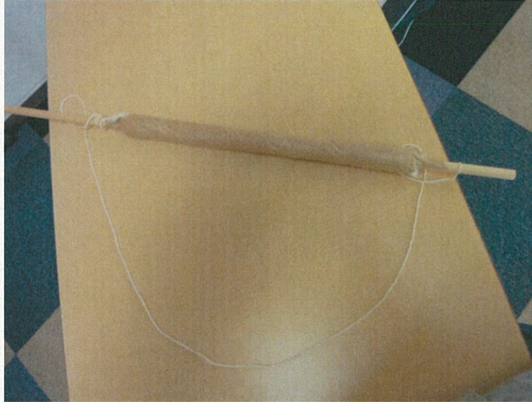
図 4: 木の棒に雑巾を巻き、ガムテープで固定したもの
