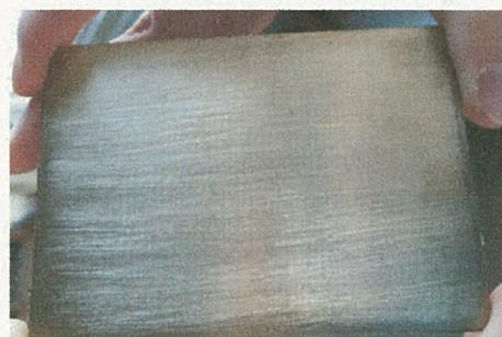
以上より、垂直の場合の静止摩擦係数の方が、水平の場合の静止摩擦係数よりも大きくなった理由として考えられるのは、垂直の場合の方が水平の場合よりも真実接触面積が大きくなつたからという事である。
