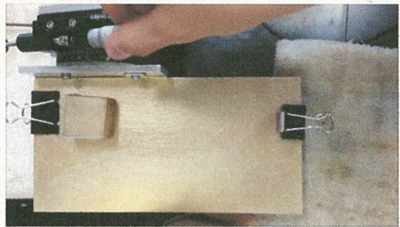
図 15 キャノーラ油を塗布した際の滑る様子( t は滑りはじめからの時間)
