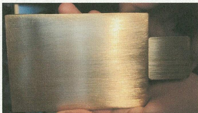
図 4-9 より、板に注目すると、うねが曲がっているのが確認でき、また大きな傷もうねを横切るようにできているのがわかる。ブロックに注目すると、うねはほぼ平行になっているが、うねの幅の間隔が一定ではないことがわかる。よって、仮定はある程度正しいものだ
