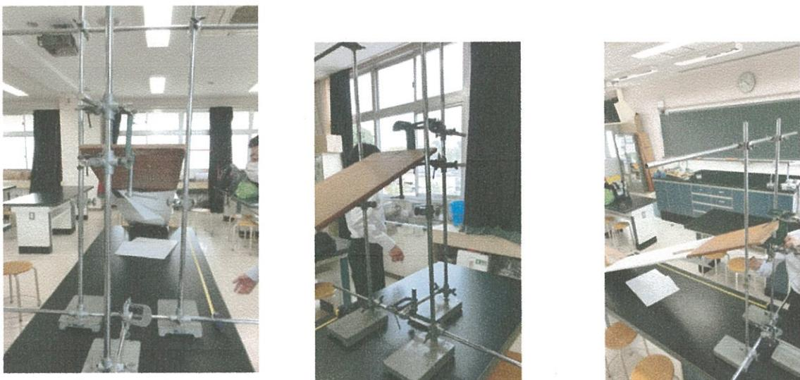
Figs.28 摩擦角測定装置の実体図と実際の実験の様子
