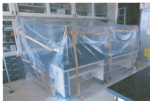
Fig.9 実験に使用した密閉空間
