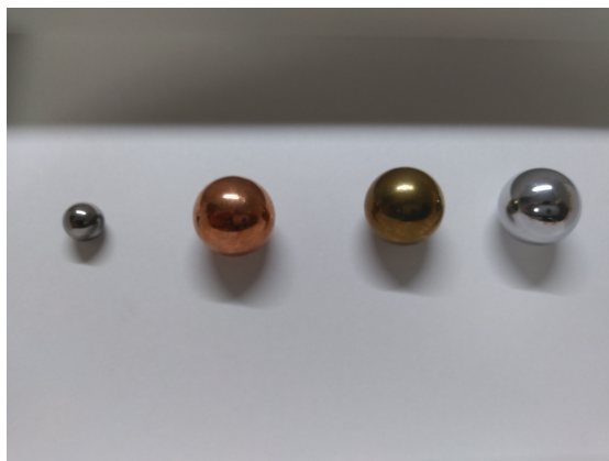
図2 実験に用いた金属球（左から鉄球，銅球，真鍮球，アルミ球）
