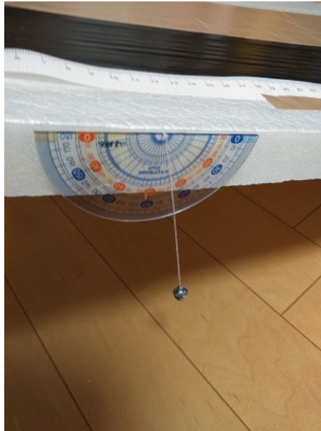
図 21 斜面への取り付け方法
