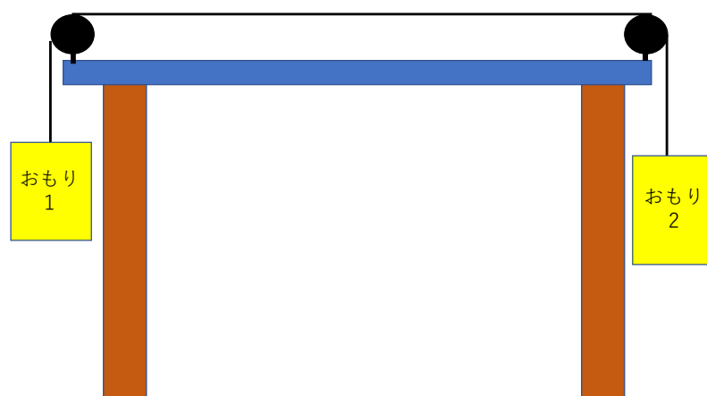
図 2 6 追加実験 1－1 滑車の抵抗力の測定
