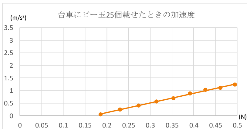
図 2 3 横軸が台車にかかる糸の張力(N)、縦軸が加速度(m/s 2 )
