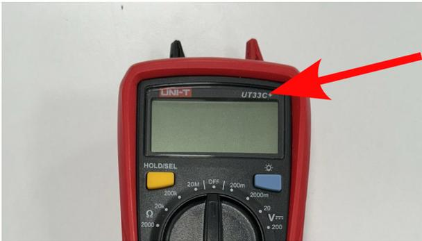
図 5: 赤い矢印はデジタルマルチメーターの型番の位置を示している。
