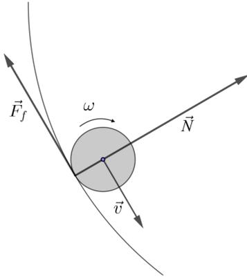
まずはじめは、滑りながら転がる運動を考えよう。壁からパックに働く垂直力  $\vec{N}$  はいつもパックの速度に対して垂直である。力  $\vec{N}$  は速度  $\vec{v}$  の方向を変える。垂直方向に対するニュートンの法則より、 $N = mv^2/R$  であることが分かる。ここで、 $m$  はパックの質量である。これから、摩擦力の大きさは  $F_f = \mu N = \mu mv^2/R$  である。
