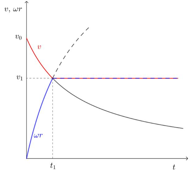
対称軸のまわりのパックの回転は、パックの壁との接点に働く摩擦力のトルク、 $M_f = rF_f = r\mu mv^2/R$ 、によって引き起こされる。ここで、パックの半径  $r$  は腕の長さになる。ニュートンの第二法則  $I d\omega/dt = M_f$  から、パックの回転運動の方程式は
