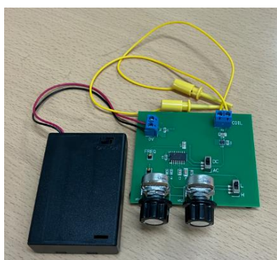
4. 駆動用回路基板セット (リード線の色は異なる場合がある)
